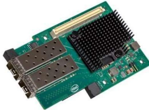
A placa de interface de rede Intel X710, Ethernet da Dell™ é ideal para conectar o servidor à rede. O adaptador do servidor de porta dupla provou ser uma solução confiável baseada em padrões. Esse produto foi testado e validado em sistemas Dell. Qua ... [Mostrar mais](#)
