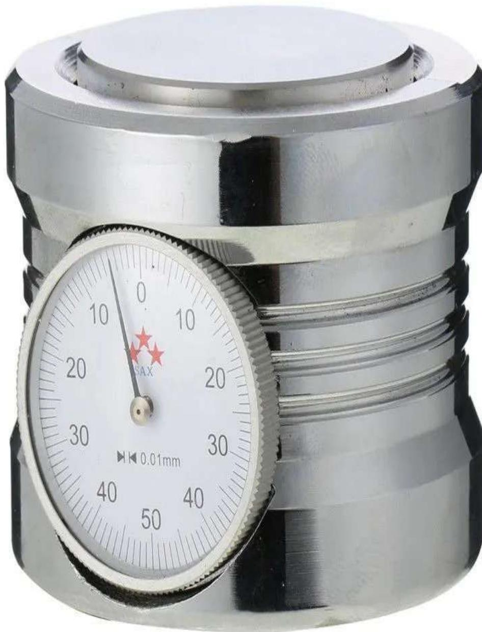
O Presseter é um instrumento de medição utilizado em Centros de Usinagem para ajuste e medições de ferramentas.
