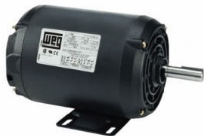
Motor Trifásico Aberto - 1,00cv - 4 Polos - 220/380V - WEG
